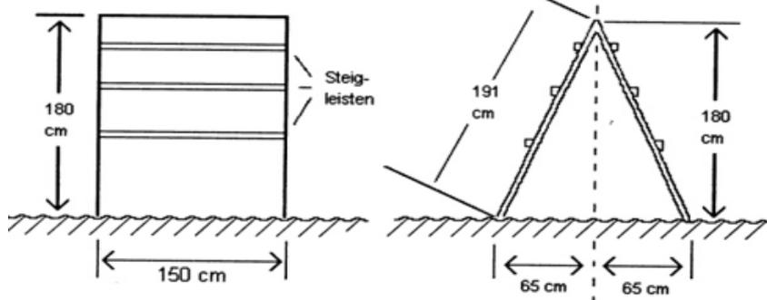
La palissade est composée de deux parties fixées solidairement d'une largeur de 150 cm et d'une hauteur de 180 cm. Au sol, ces deux parties sont écartées de telle façon que le sommet se situe à 180 cm. Toute la palissade doit être recouverte d'un revêtement antidérapant. Dans la partie supérieure des côtés, sont disposées 3 lattes (24X48 cm), pour faciliter le franchissement.
